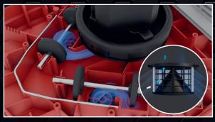
Le filtre est nettoyé par rétrolavage à l'air et, grâce à la cartouche filtrante brevetée, les pores fins du filtre sont débarrassés de la poussière sans laisser de résidus. Il n'est pas nécessaire d'entretenir ni de nettoyer le filtre. Ainsi, vous économisez du temps et de l'argent.
