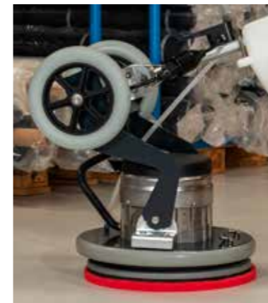
Kippbare Deichsel zur Erhöhung des Anpressdruckes.
